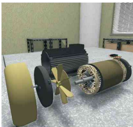
Рис. 7. Асинхронный двигатель с КЗ ротором (разобран)
